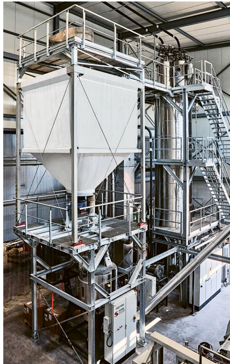
Une nouvelle extrudeuse a été installée chez RecyPet à Frauenfeld. Elle transforme les bouteilles à boissons en PET en granulat de PET de qualité alimentaire.
