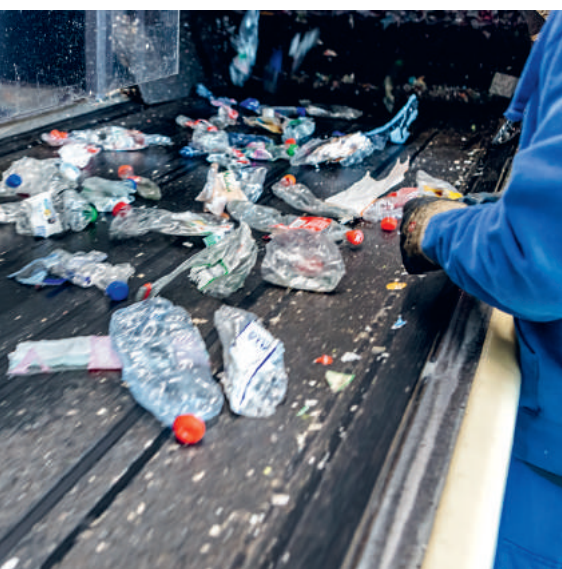
Aux côtés de Zoltán Gál, responsable de l'installation, Tassilo Waldraff inspecte les produits à trier. (en haut et au milieu). Est-ce une bouteille à boissons en PET ou non: aujourd'hui, c'est encore aux collaborateurs sur le convoyeur de trancher (bas).
